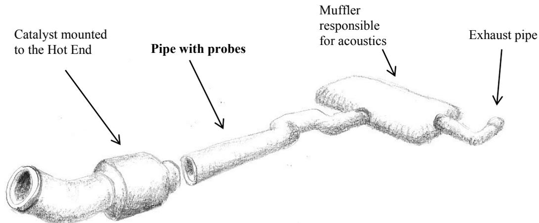
**Figure 1.** Diagram of parts included in the Cold End system. Based on: Wróbel K.: Analiza i doskonalenie procesu produkcji rur z wstawianymi sondami. Praca magisterska obroniona na Wydziale Organizacji i Zarządzania Politechniki Śląskiej pod kierunkiem dr inż. Krzysztofa Michalskiego, Zabrze 2020.
